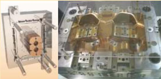
Aufgrund der hohen Wärmeleitfähigkeit von Kupferlegierungen wird es in solchen Formen bevorzugt. Niedriger Lastspielzahl sparen Zeit und Kosten. Die am häufigsten verwendeten Hartkupferlegierungen in dieser Anwendung sind **Cupro CB, CNB, NS, NSM** und **B2** Legierungen.
