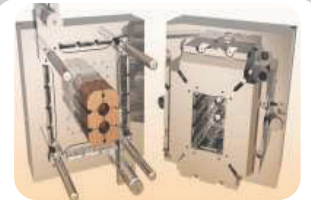
Plastik kalıpta bakır uygulaması.
