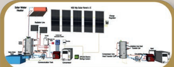
TÜRKPATENT 2024/000689 Başvuru numaralı "Güneşten üretilen ısı ve elektrikle desteklenen, entegre kompresör atık ısı geri kazanım sistemi"
